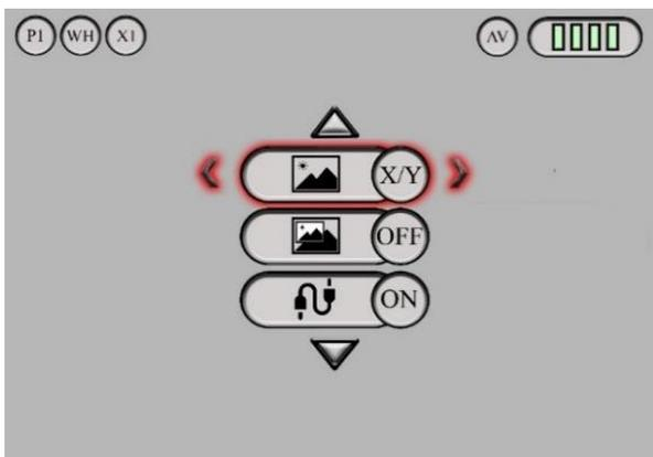
При открытии данного пункта откроется подменю. В верхней части подменю отображаются координаты дисплея по осям X и Y. В режиме насадки в заводских условиях устанавливаются координаты X и Y в профиле №1. На других профилях можно изменять и запоминать координаты X и Y для корректировки пристрелки на разные дистанции или для разного оружия, или для разных дневных прицелов.
